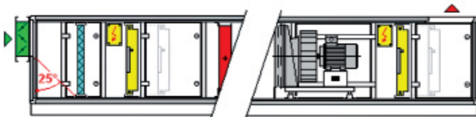
Электростатический фильтр абсолютной очистки, извлекаемый спереди, через смотровой люк.
