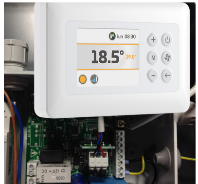
T-MB2 clamps n° 5,6,7 connection
