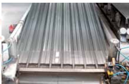
Essai d'étanchéité des collecteurs
