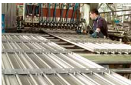
Soudure automatique des cornières de suspension
