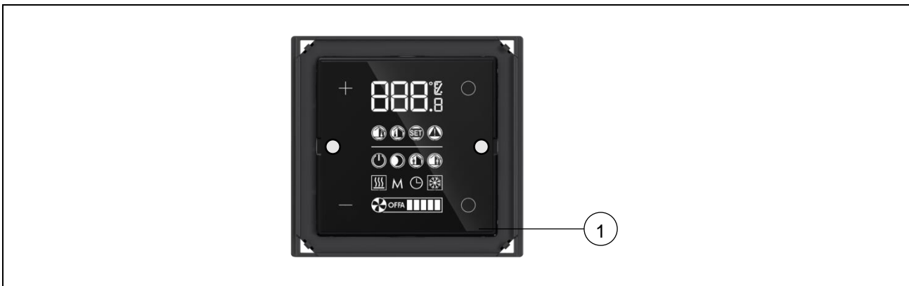
Posizionamento del sensore interno di temperatura (1).
